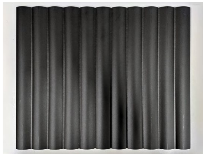
5軸CNC作成した波板模様屏に真空加工で化粧シートを貼付
